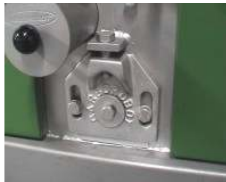
1.22 Регулировочные корпуса подшипников
