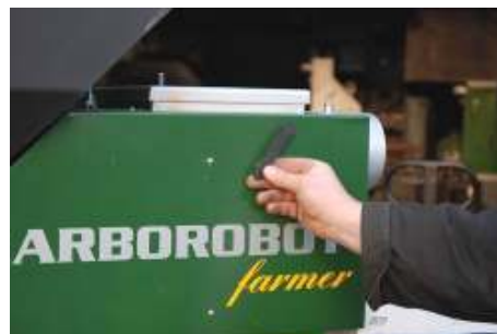
1.28 Рычаг для открытия отверстия отсоса дымовых газов
