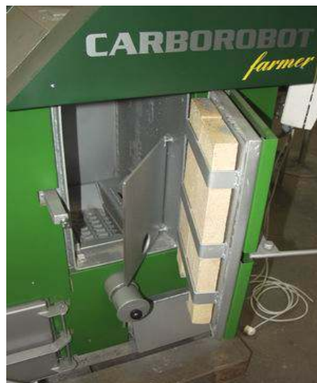
1.23 Дверь топочной камеры древесины
