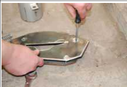
Пластинка укреплен на держателе с 4 болтами. Выкрутите их и положите другую пластинку на держатель.
