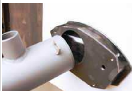
Можно его выбирать через дверь зольника. Если горячий используйте перчатки.
