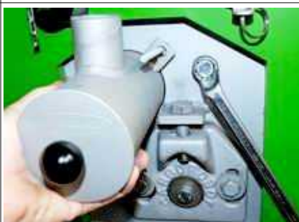
С ключом двигайте держатель и с другой рукой нажимайте трубу пока он не заходит в люк держателя. Можно чувствовать когда уже на месте, тогда уже ключ не двигает держатель свободно от трубу.
