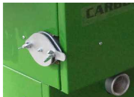
1.20 Люк для очистки пылеотделителя.
