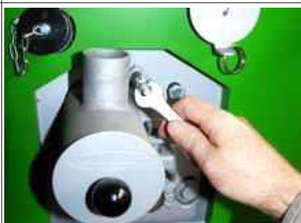
Если успешно положили трубу на месте, потом нужно положить обратно пружины и гайки. Надо скромно натянуть пружины и конце всего проверяем, что воздушная труба и держатель встречались правильно. Если пружины слишком сильно натянули, тогда поворотная решетка трудно поворачивается или сталкивается.
