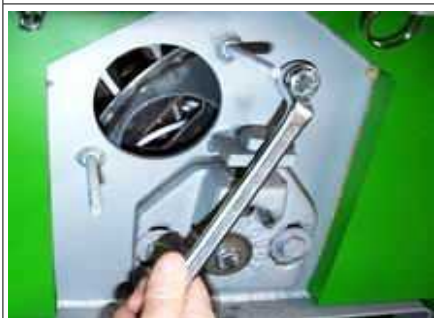
Затягиваем болт 17мм и потом с помощью ключа двигаем держатель в такую позицию что воздушную трубу могли сплотить в люк держателя.
