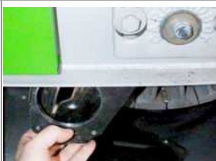
Можно его выбирать через дверь зольника. Если горячий используйте перчатки.
