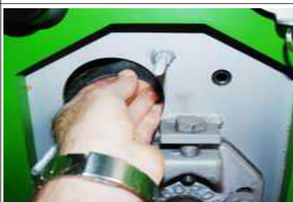
С рукой или с отверткой держатель двигайте к дырку болта 17мм.
